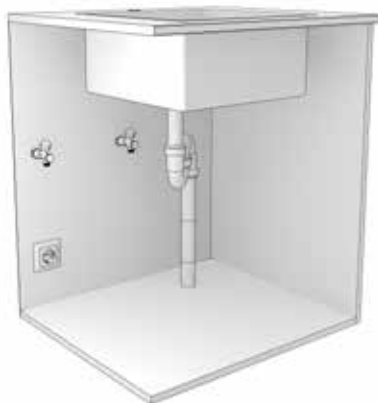
Single installatie beginsituatie - Selsiuz Classic boiler - beginsituatie
